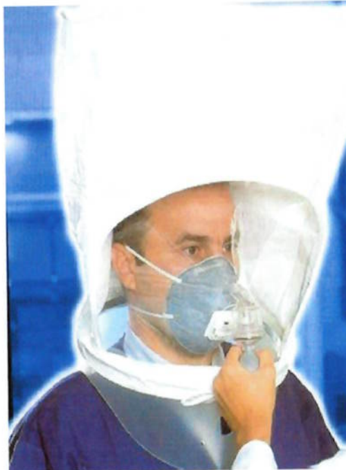
Fig. 10. Ensaio de vedação qualitativo com uma PFF. (Cortesia: 3M)
