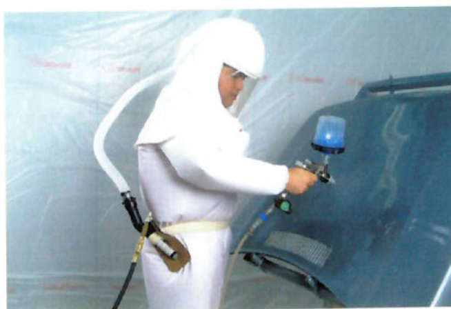
Fig. 18. Respirador de adução de ar tipo linha de ar comprimido com cobertura facial do tipo capuz. (Cortesia: 3M)
