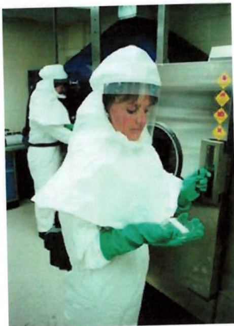
Fig. 7. Respirador purificador de ar motorizado com cobertura facial do tipo capuz. (Cortesia: 3M)
