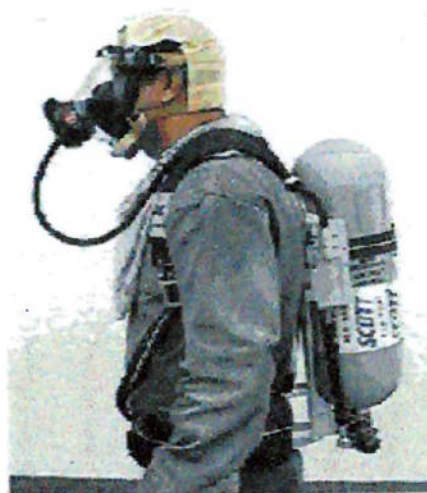
Fig. 20. Respirador de adução de ar tipo máscara autônoma de demanda com pressão positiva e peça facial inteira. (Cortesia: 3M)
